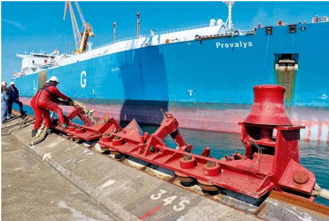
Des treuils couissant le long du quai permettent d'ajuster l'angle et la tension des aussières au fur et à mesure de la descente du bateau, selon les indications des dock masters. © Mélanie Joubert
