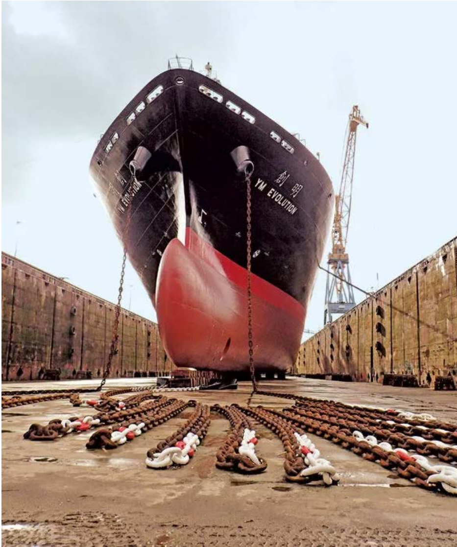
Le YM Evolution , porte-conteneur chinois de 260 mètres de long, parfaitement échoué sur ses tins dans la forme numéro 2. © Sandrine Pierrefeu
