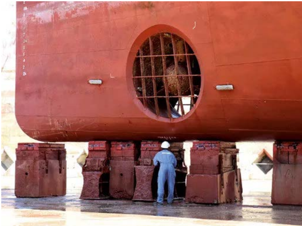
Un autre bassinier vérifie que le poids du navire est bien réparti sur les tins et qu'aucun appendice n'a été endommagé ou masqué. © Sandrine Pierrefeu
