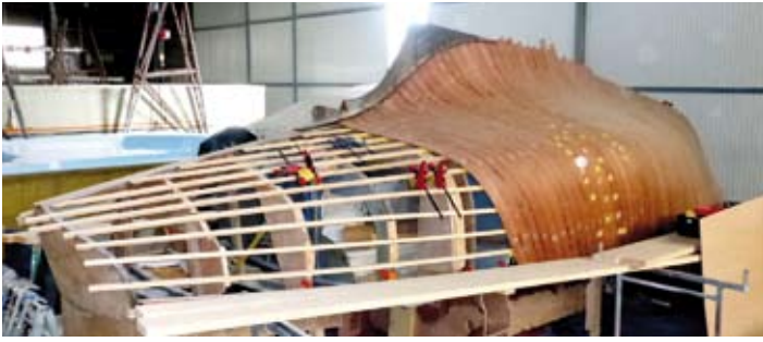
La coque de Damien en reconstruction, toutes les lisses ont été reprises
